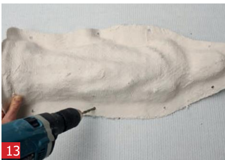
如果需要，可以在A1支撑模具上钻孔以增加螺栓和螺母。
