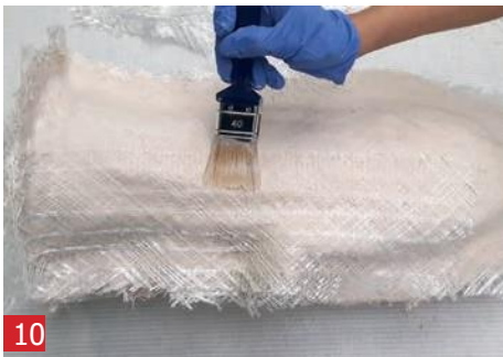
再次用A1刷此层。重复上述步骤，直到应用了4层A1三轴纤维。
