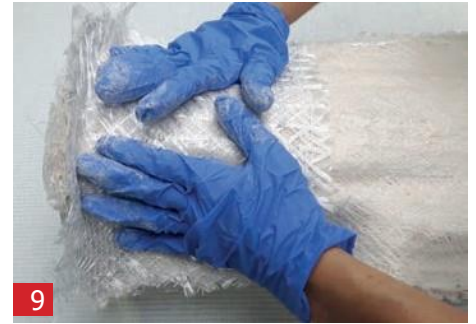
按下A1三轴纤维。纤维可以很好地成形/成形。
