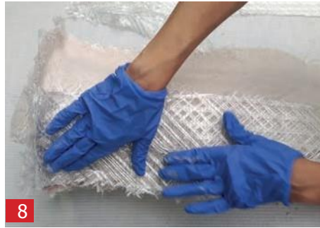
并在仍湿的A1上涂覆第二层A1三轴纤维。
