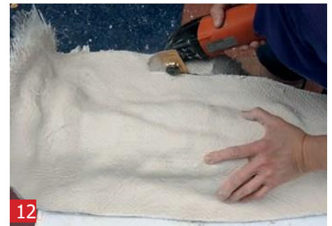
如果需要，可以使用多功能工具完成A1支撑模具。
